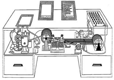
Il sistema (chiamato Memex) era basato su un meccanismo di fotografia e microfilmazione automatica di fogli, sulla possibilità di punzonare secondo codici prestabiliti i microfilm, e su un meccanismo di ricerca rapida di microfilm sulla base di queste punzonature.
